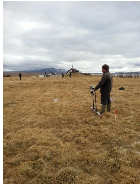
Mynd 3: Viðnámsmæling á Þingeyrum, bærinn sést í baksýn (ljósmyndari: Steinunn Kristjánsdóttir).
