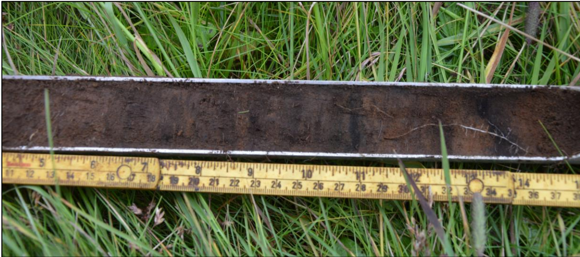
Mynd 10. Mögulegt torf í kjarna 10.1. Dökkbrúnt og rauðljósbrún jarðlög með gjóskulínnum
