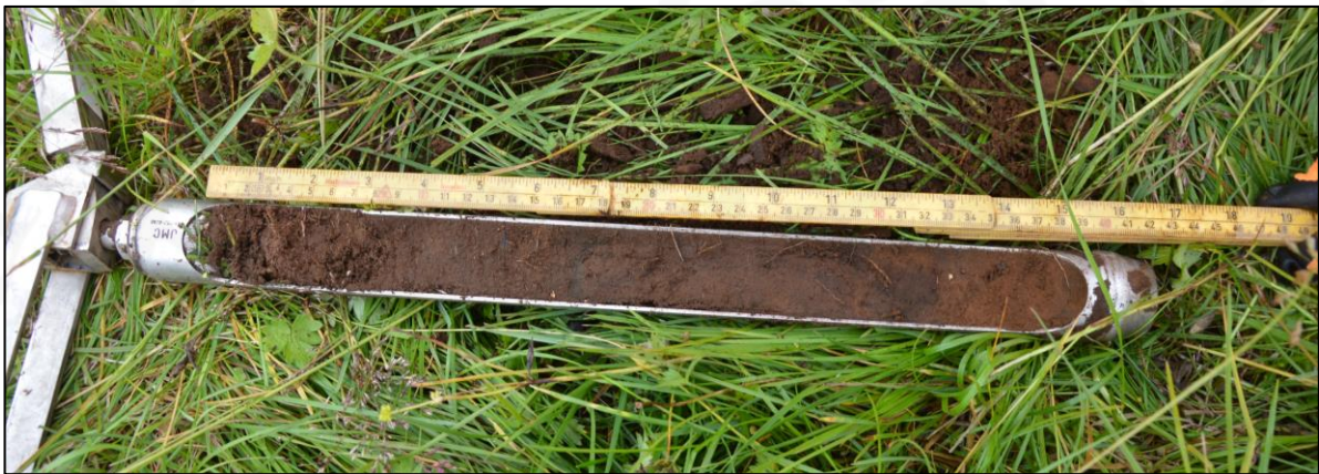
Mynd 5. Borkjarni 3.3. Dökkbrún lífræn jarðlög sem benda til þess að þarna hafi verið tún lengi.
